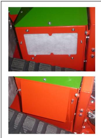
Die Kühlluft für den E-Kasten wird durch eine Filtermatte auf der rechten Seite gereinigt. Bei einer verunreinigten Filtermatte ist die Kühlleistung vermindert.
