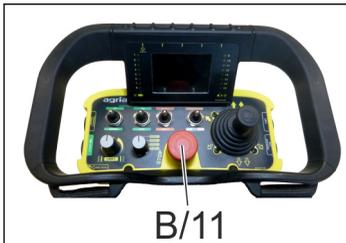
Alle anderen Befehle werden beim normalen Arbeiten über den Sender der Fernbedienung erteilt. An der Fernbedienung kann die Motordrehzahl und die Schnitthöheneinstellung voreingestellt werden, auch während der Motor aus ist.
