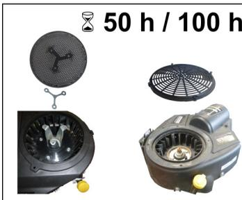
1.) Rotierendes Lüfterrad mind. alle **50** Betriebsstunden (bei starkem Staub- und Pflanzenrestenanfall früher) reinigen; hierzu das Lüftergehäuse abbauen.
