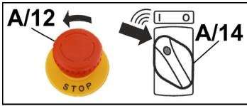
❶ Auf der Maschine NOT-AUS-Schalter (A/12) entriegeln (nach links drehen) und die Zündung der Maschine mit dem Zündschalter (A/14) einschalten - Piepston ertönt.
