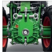
agria-Anbauflansch: einfacher und schneller Anbaugerätewechsel
