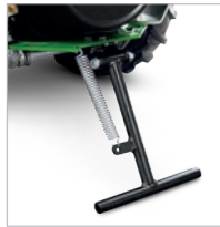
Stützfuß erleichtert das Abstellen der Maschine
