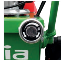
Stufenlose Einstellung der Bürstendrehzahl
