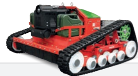
Agria-Wechseltanksystem, Füllstandsanzeige auf Fernbedienung
