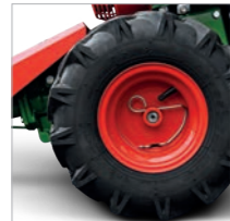
Einfaches Lenken und Manövrieren durch Freischaltung der Räder
