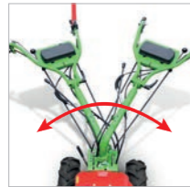
Lenkholm in beide Richtungen seitlich schwenkbar
