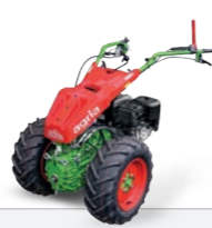
Portalachse zur Schwerpunktverstellung
