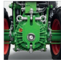
agria-Anbauflansch: einfacher und schneller Anbaugerätewechsel
