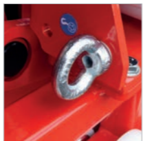
Sicheres Verladen über Verzurrösen
