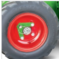
Radmitnehmer: wahlweise Einzelrad- oder Zweiradantrieb
