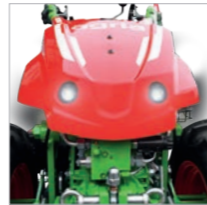
Gute Sichtbarkeit durch LED-Sicherheitsleuchten
