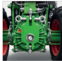
agria-Anbauflansch: einfacher und schneller Anbaugerätewechsel
