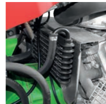
Zusätzlicher Ölkühler für den Einsatz auch bei großer Hitze
