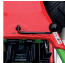
Sicheres Abstellen der Maschine mit zentraler Feststellbremse
