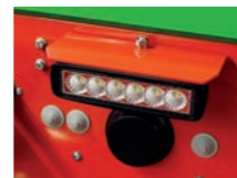
LED-Funktionsscheinwerfer mit visueller Warnfunktion
