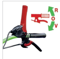
Sicheres Schalten durch Einhandwendschaltung
