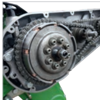
Robustes und langlebiges Kettengetriebe im Ölbad
