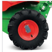
Einfaches Lenken und Manövrieren durch Freischaltung der Räder
