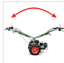
Lenkholm um 180° drehbar
