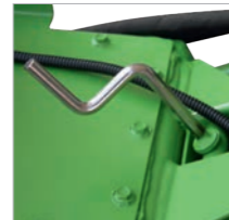
Stufen- und werkzeu-lose Höhenverstellung des Lenkholms per Kurbel
