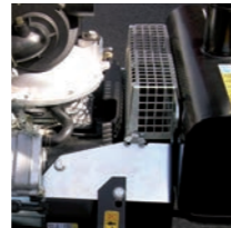
Optimierte Luftansaugung schützt den Motor vor Überhitzung
