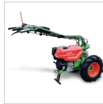
Lenkholm um 180° drehbar
