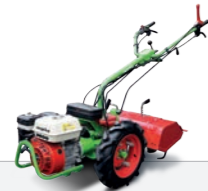
Lenkholm um 180° drehbar
