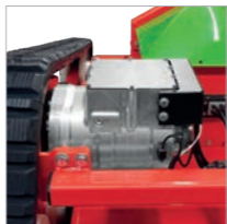
Bürstenlose und somit wartungsfreie Elektromotoren
