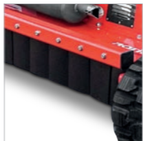
Schutz vor Steinschlag: Wurfkörperprüfung nach DLG
