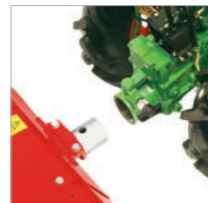
Rohrbaufansch: einfacher und schneller Anbaugerätewechsel
