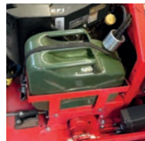
Agria-Wechseltanksystem, Füllstandsanzeige auf Fernbedienung
