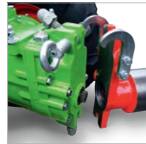
agria-Anbauflansch: einfacher und schneller Anbaugerätewechsel
