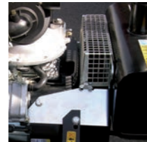
Optimierte Luftansaugung schützt den Motor vor Überhitzung
